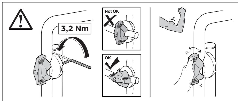
**UK Перевірте натяг.** Після певного періоду часу може знадобитися перевірка натягу в ручці. Затягніть гвинт із шестигранною головкою на півоберту та перевірте, чи збільшується опір у ручці під час її обертання.
